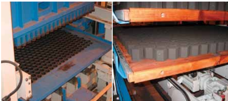
Kuva 3. Briketointikoneen muotti ja valmiit briketit alustalla.
