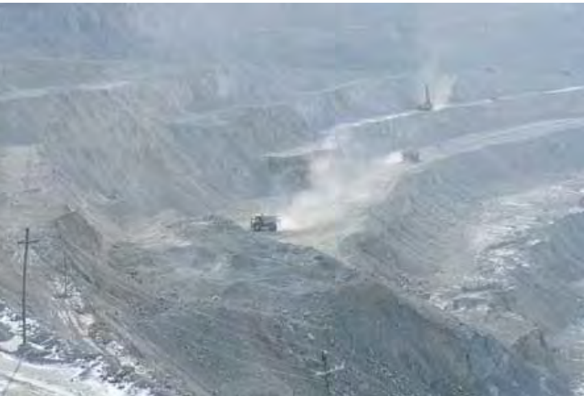
Erdenet Mining Co. toinen avolouhos, joka tuottaa sekä kupari-että molybdeenirikasteita vientiin ja osa rikastushiekasta käsitellään kasaliuotustekniikalla kuparin tuottamiseksi pienessä SX-EW laitoksessa.
